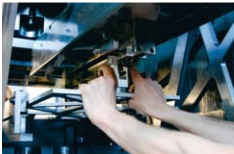
Schnellkupplungssystem für rasches Umrüsten.
