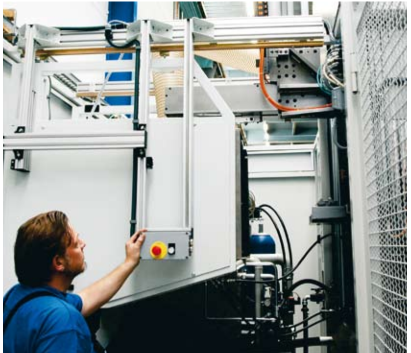
Integriertes Räumsystem für einfaches Umrüsten von Blasen auf Räumen.
