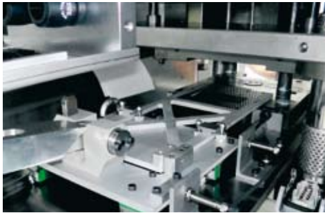
Ein hochdynamischer Linearmotor sorgt für schnelle Taktzahlen.
