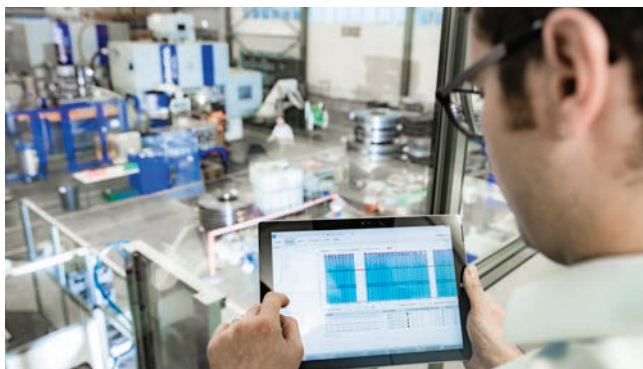
Auf einen Blick: Feinmonitoring liefert alle relevanten Messdaten der Presse laufend und warnt, bevor Störungen auftreten.
