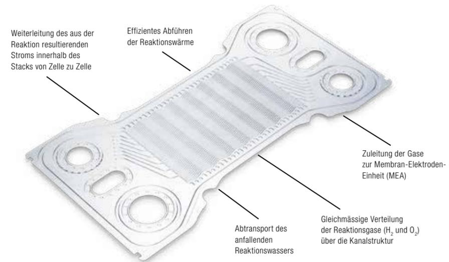
Die Verringerung von Gewicht, Materialstärke und Volumen der 200 bis 400 im Stack verbauten Bipolarplatten («Repeating Cells») führen zu einer höheren Leistungsdichte.
