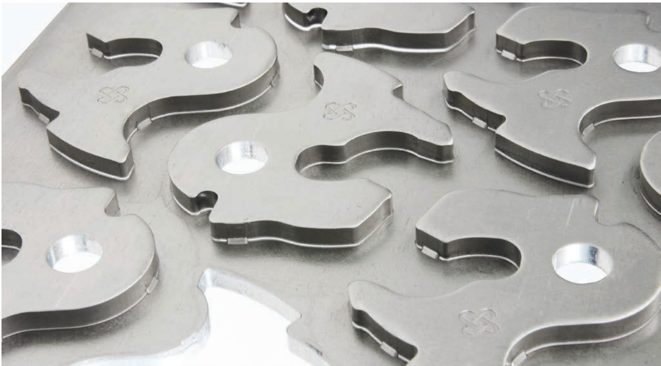
Streifen aus Speed Feinschneidwerkzeug mit patentierter Teileanbindung.
