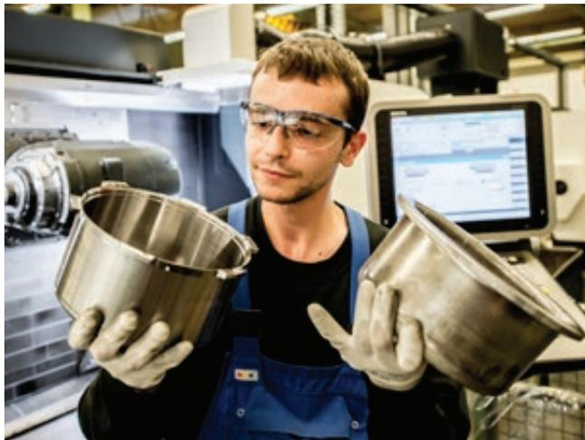
Hybrid-Bauteile: mehrfach gezogen und auf einem Dreh- und Fräszentrum bearbeitet
