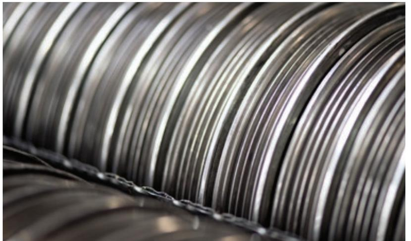
Spanlos rolliertes Poly-V-Profil für Riemenscheiben
