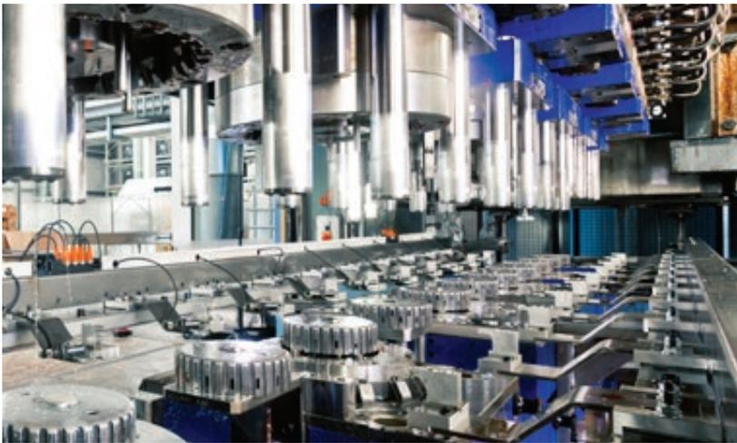
Stufenpresse: Großproduktion von Lamellenträgern an zwölf Werkzeugstationen
