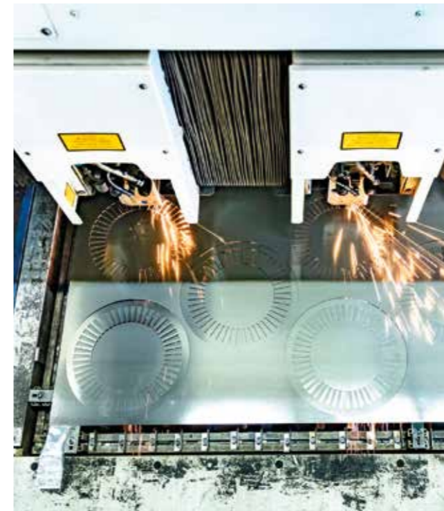
Laserschneiden: Hochflexible Herstellung von Prototypen in kleinen und mittleren Stückzahlen auf modernsten Laseranlagen
