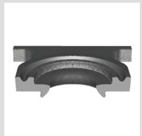
Teilequerschnitt nach Stufe "Durchsetzen"
