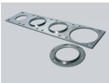
Streifen aus dem 4-stufigen Werkzeug mit Zieh- und Kalibrierstufen
